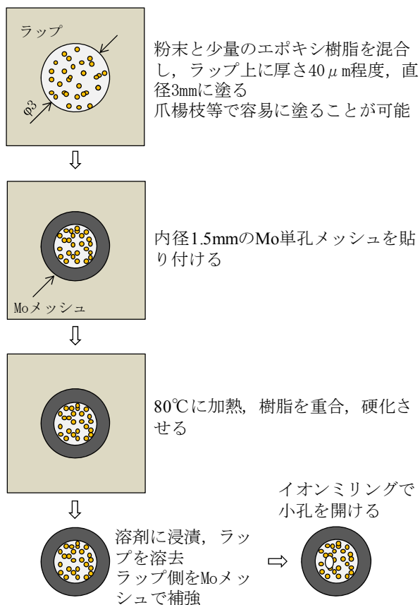
Fig.3 簡便な粉末薄片化法
