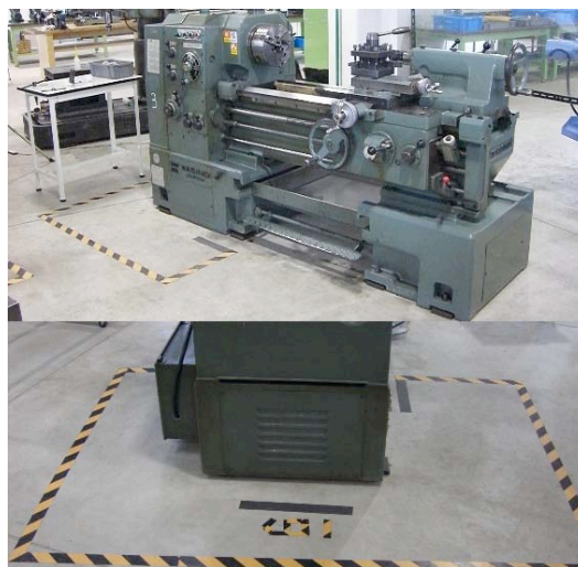
Fig.8 虎縞テープによる進入禁止の表示
