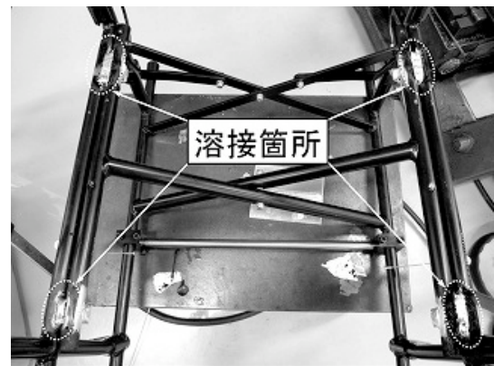
写真6 アルミパイプフレームの溶接
