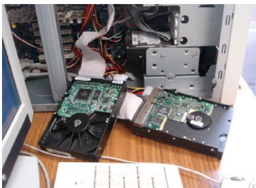
図 1. PC の内部と HDD の接続例
