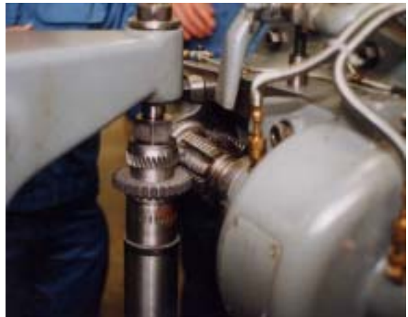
写真3 ホブ盤によるホブ切り加工
