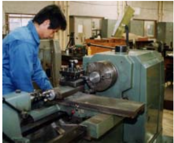
写真2 旋盤によるブランク製作
