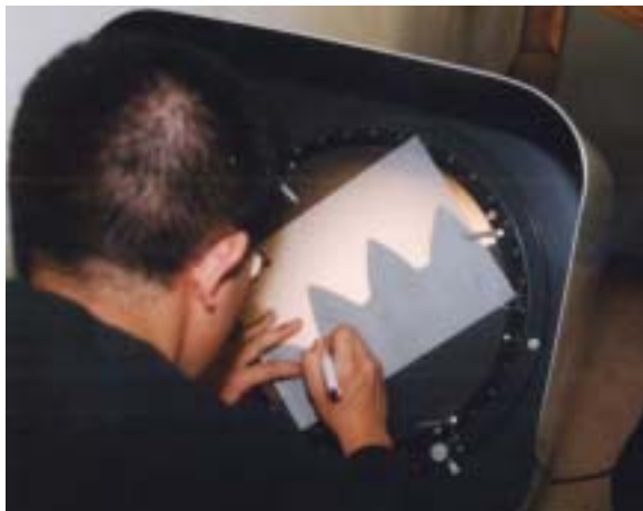
写真5 万能投影機によるトレース
