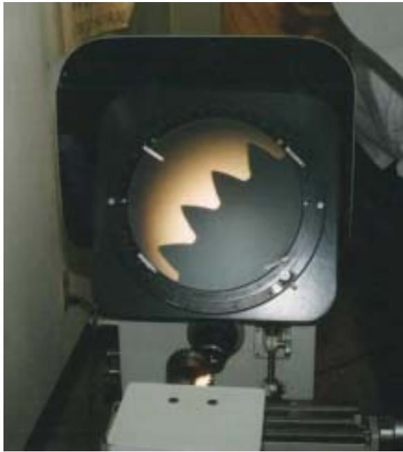
写真4 投影機による歯車の拡大(10倍)
