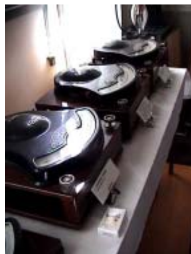
写真1 学生実験器材室から重要文化財内展示室に移送した電流力計型の精密電圧計、電流計、電力計（机上手前中央は煙草箱）
