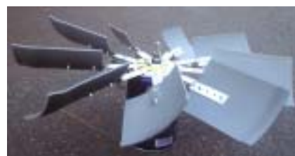
ライト管をカットした曲面翼の風車
