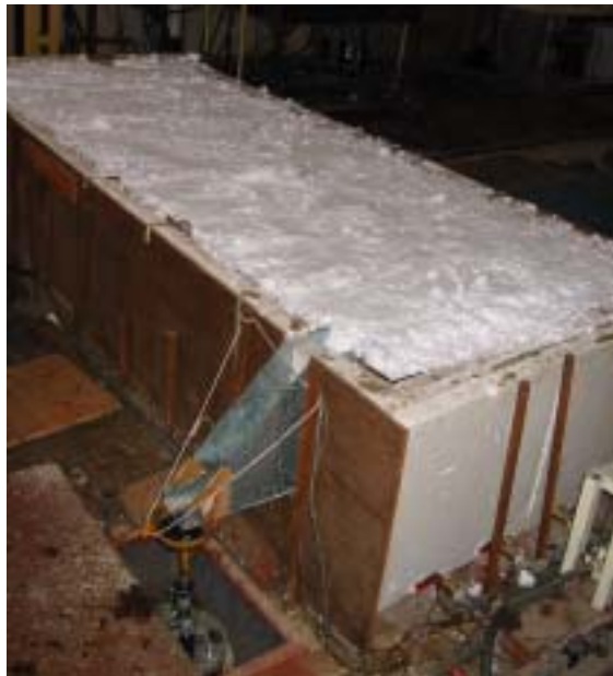
図2 無雪道路モデルに冠雪させた様子
