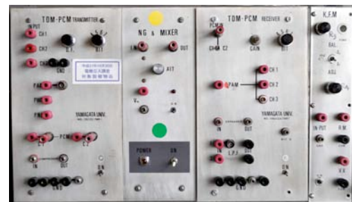
【図2】時分割多重PCM実験装置 本体の前面パネル
