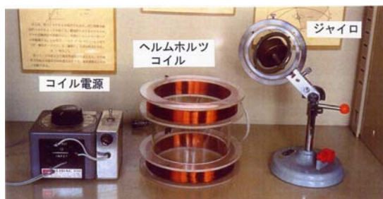
図 1 角運動スピンを理解するために試作開発したマグジャイロ
