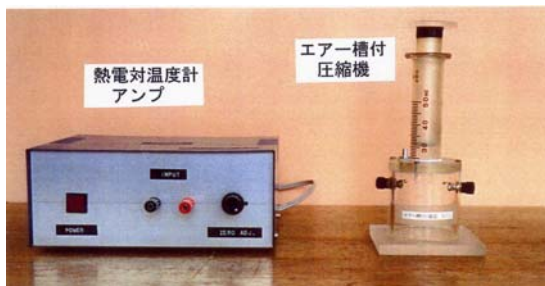
図3 熱機関の原理を理解するために 製作したワーキンピストン
