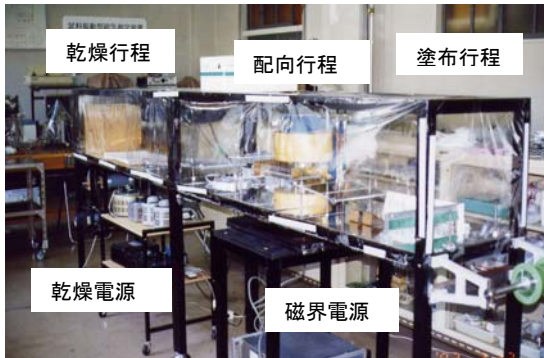
図 5 自作した磁気テープ試作装置
